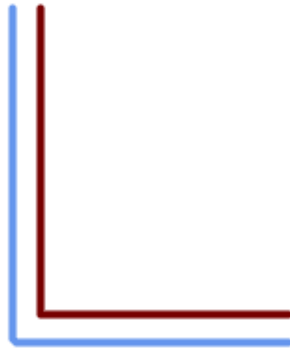
-15, 'quad_segs=4 join=round' ligne originale et son décalage de -15 unités
